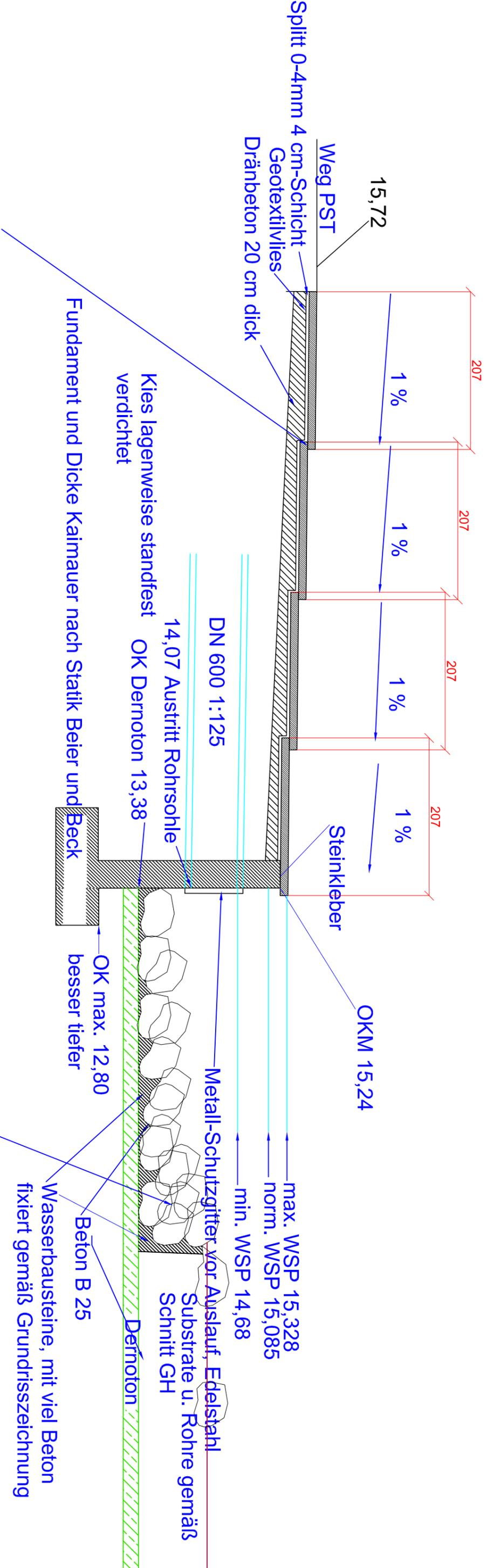
Überlappungsbreite der Stufen variiert aufgrund des geometrischen Zuschnitts der Treppe: entlang der rosa Hilfslinie auf dem Treppengrundriss: engere Überlappung (7 cm), nach außen hin ergibt sich eine breitere Überlappung (am Kontaktpunkt zur nördlichen Kaimauer bis 27 cm Überlappung) zu Natursteinmauer aufmauern
